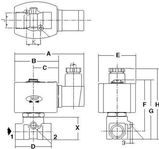
**Magnetventil, stromlos geschlossen, direktgesteuert, 230 V, 50 - 60 Hz**
